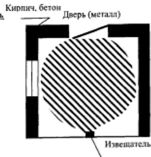
Вариант 7. Блокировка двери на открывание и проникновение извещателем объемным радиоволновым (комбинированным)
