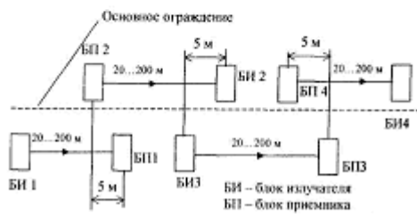
Вариант 1. Блокировка основного ограждения извещателями линейными радиоволнами
